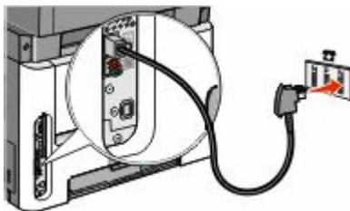
**4** Per utilizzare la stessa linea sia per la comunicazione fax che telefonica, collegare una seconda linea telefonica (non fornita) tra il telefono e lo slot F di una presa a muro telefonica analogica attiva.
