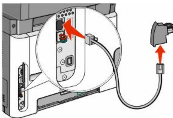
**3** Collegare l'adattatore nello slot N di una presa a muro telefonica analogica attiva.
