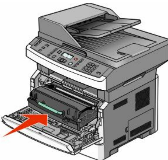
**8** Dopo aver sostituito il kit fotoconduttore, azzerare il contatore del fotoconduttore. Per azzerare il contatore, vedere il foglio di istruzioni fornito con il nuovo kit fotoconduttore.
