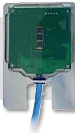
**KET-SIR-200** è un solarimetro digitale dotato di una cella in silicio monocristallino. Le caratteristiche costruttive e il livello di precisione della misura lo rendono paragonabile ad un piranometro.
