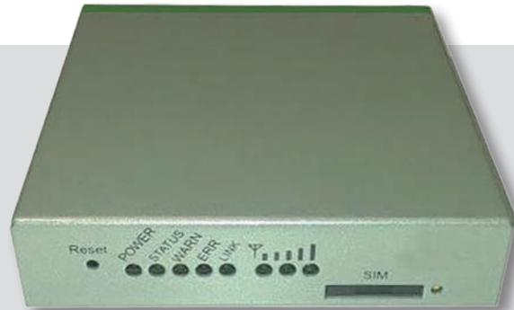
**KET-MUM-100** è un dispositivo che integra al suo interno un modem UMTS di ultima generazione, un router ed una uscita Ethernet.
