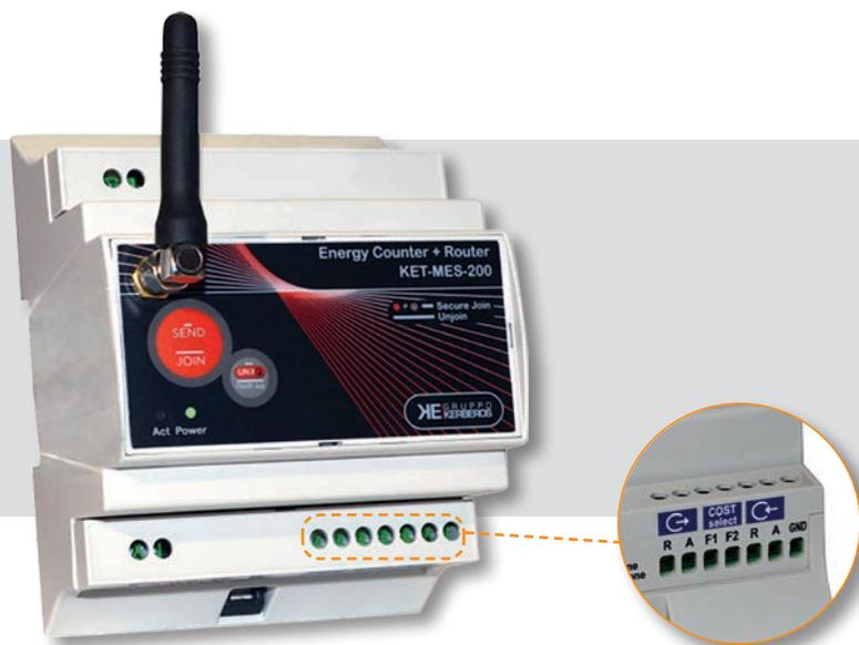
**KET-MES-200** si collega all'interfaccia ES (emissione segnali) standard dei contatori di energia elettrica e conteggia gli impulsi relativi ai consumi di energia prelevata e ceduta alla rete elettrica, oltre a due canali di fascia tariffaria.
