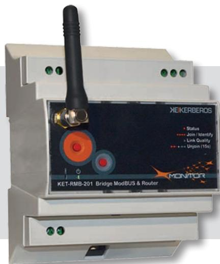
**KET-RMB-201** è in grado di gestire fino a 32 dispositivi slave ModBUS RTU connessi alla sua porta RS485. Il dispositivo può essere programmato per leggere una serie di registri ed inviarli al Gateway.
