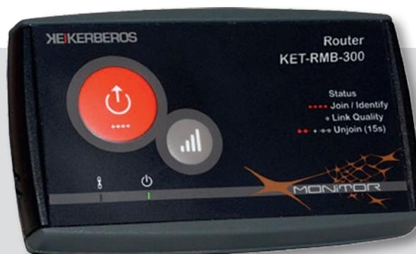
**KET-RMB-300**, insieme ai nodi con funzionalità di ripetitore integrata e al Gateway, fornisce l'infrastruttura di rete necessaria alla corretta trasmissione dei dati raccolti dai sensori wireless.
