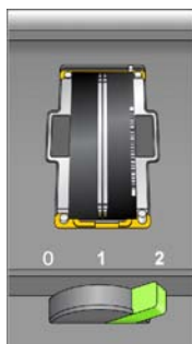
Figura 41 Leva della cella a flusso in posizione 2
