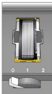
Figura 17 Leva della cella a flusso in posizione 0
