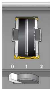
Figura 43 Leva della cella a flusso in posizione 0
