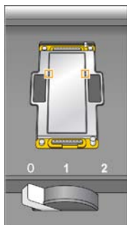
Figura 31 Ispezione dei fori della pompa a vuoto
