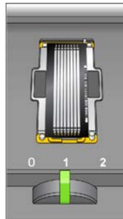
Figura 26 Leva della cella a flusso in posizione 1
