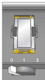
Figura 23 Leva della cella a flusso in posizione 0
