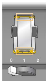
Figura 49 Rimozione delle guarnizioni dei collettori usate
