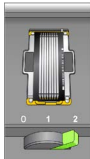
Figura 14 Leva della cella a flusso in posizione 2
