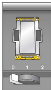
Figura 10 Leva della cella a flusso in posizione 0
