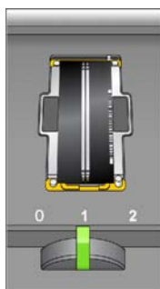
Figura 40 Leva della cella a flusso in posizione 1
