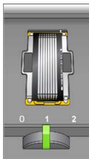
Figura 29 Leva della cella a flusso in posizione 1
