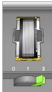
Figura 27 Leva della cella a flusso in posizione 2
