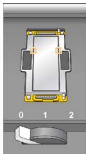
Figura 44 Ispezione dei fori della pompa a vuoto
