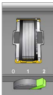
Figura 34 Leva della cella a flusso in posizione 2
