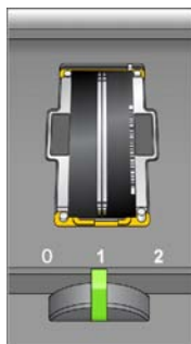
Figura 46 Leva della cella a flusso in posizione 1
