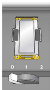
Figura 37 Leva della cella a flusso in posizione 0
