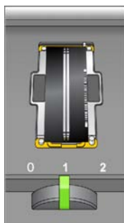
Figura 42 Leva della cella a flusso in posizione 1
