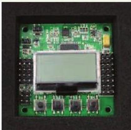
**STEP-1** Montare la kk2 sul telaio con il display LCD rivolto verso Anteriore ed i pulsanti fronte retro.
