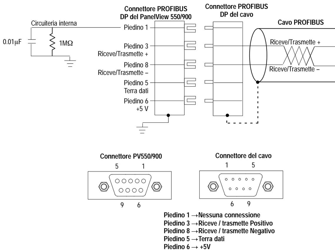
**Nota:** Connettere la schermatura del cavo alla protezione metallica del connettore. Il guscio dei connettori PanelView è connesso alla terra dello chassis.
