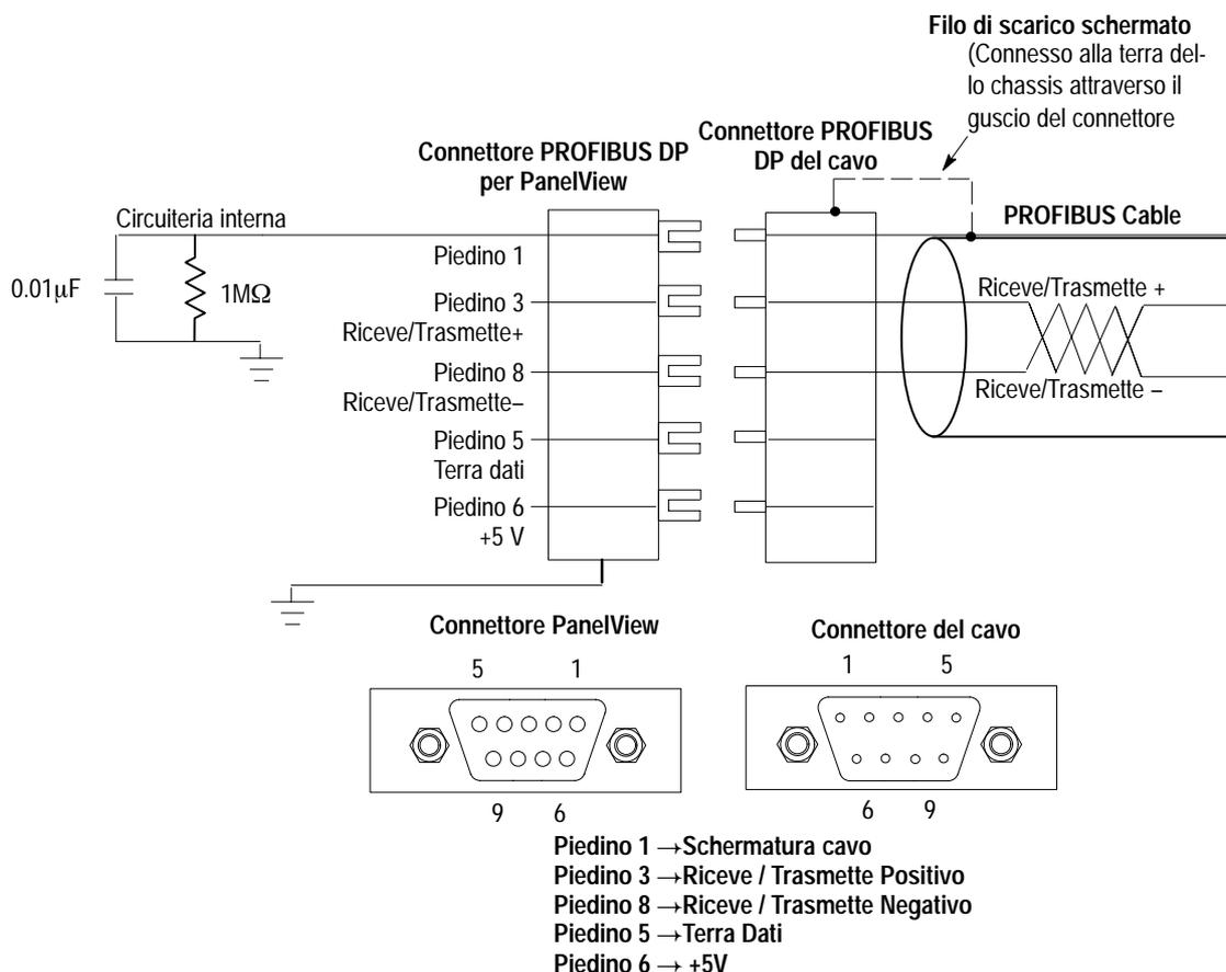
**Nota:** Connettere lo schermo del cavo al piedino 1 del connettore. Per la rispondenza alle direttive europee per la Compatibilità Elettromagnetica (EMC), connettere lo schermo del cavo anche al guscio metallico del connettore su entrambi i lati della connessione. Così si connette lo schermo del cavo alla terra dello chassis tramite il guscio del connettore e si esclude il filtro R/C.
