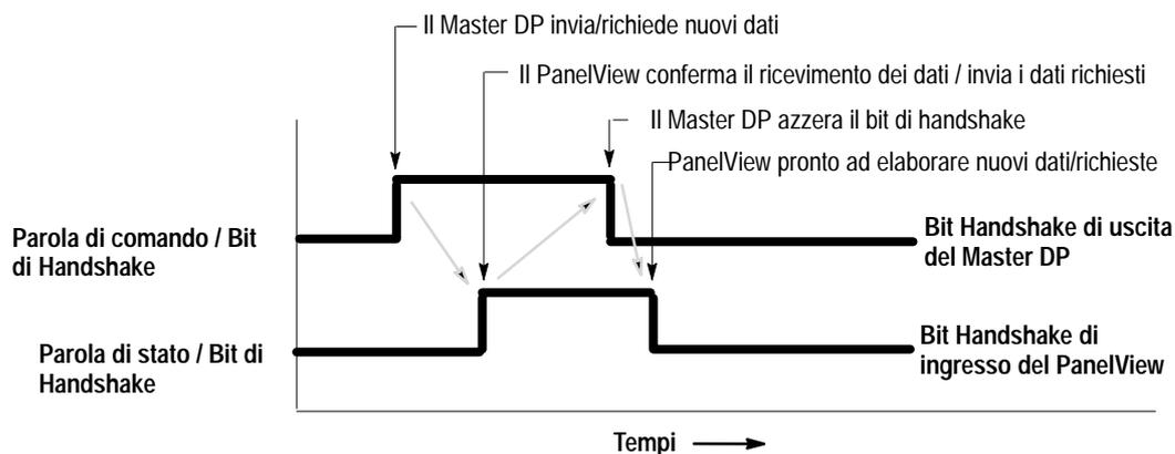
Le procedure seguenti sono necessarie per iniziare e completare uno scambio di dati del modulo multiplex dal Master DP.
