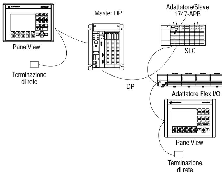
**Nota:** Per gli ambienti con disturbi elevati si raccomanda di fare le connessioni di rete utilizzando un “collegamento a festone” come indicato sopra.
