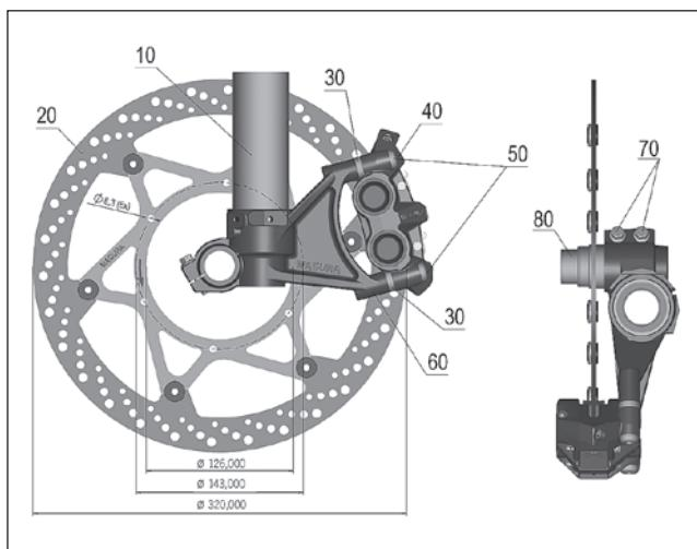
Pour les modèles 660 (2003, 2004, 2005) et 640 Supermoto (2005), vous avez en outre besoin d'une douille d'écartement (80) vu que le pont de la fourche est plus large. Comme les ponts de fourche présentent des cotes d'écartement et des moyeux différent(e)s (déviant de la série), des bagues d'écartement supplémentaires sont disponibles pour les disques de frein KTM, ces bagues présentant une épaisseur de 2,5 mm et de 4 mm.
