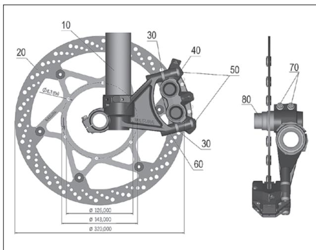
Para los modelos 660 (2003, 2004, 2005) y 640 Supermoto (2005), debe usarse también un casquillo distanciador (80) ya que el puente de la horquilla es más ancho. Debido a que desviándose de la serie, los puentes de horquilla se operan con diferentes medidas de distancia y diversos cubos, existen adicionalmente para el disco de freno KTM, anillos distanciadores con espesores de 2,5 mm y 4,0 mm.
