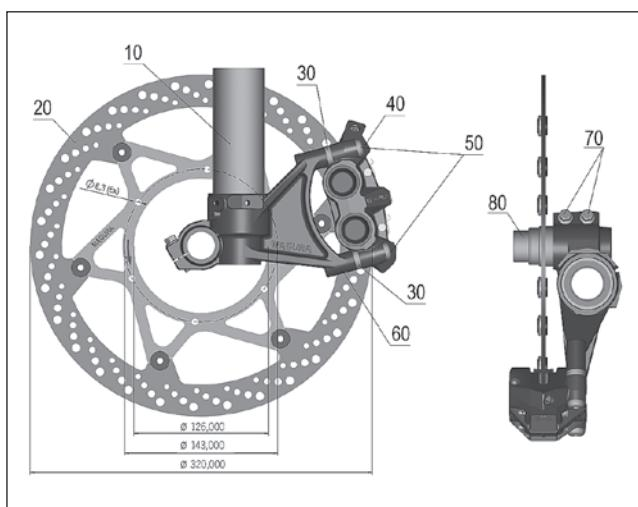
Per i modelli 660 (2003, 2004, 2005) e 640 Supermoto (2005) è necessario, in aggiunta, il distanziale a tubo (80) in quanto il ponte a forcella è più largo. Dato che a differenza dei modelli di serie si impiegano ponti per forcelle di diverse misure e mozzi differenti, sono inoltre presenti anelli distanziatori dotati di uno spessore di 2.5 mm e di 4.00 per i dischi del freno KTM.
