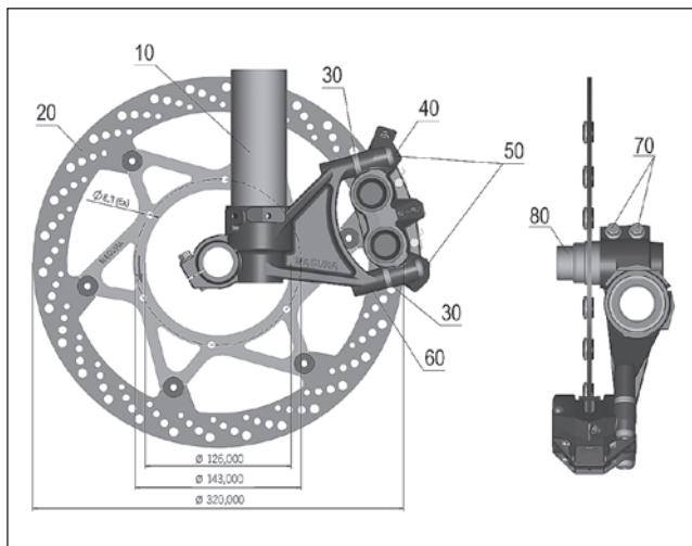
Für die Modelle 660 (2003, 2004, 2005) und 640 Supermoto (2005) ist zusätzlich die Distanzbuchse (80) notwendig, da die Gabelbrücke breiter ist. Da abweichend von der Serie Gabelbrücken mit unterschiedlichen Distanzmaßen und verschiedenen Nabengrößen gefahren werden, gibt es zusätzlich Distanzringe mit der Dicke 2,5 mm und 4,0 mm für die KTM-Bremsscheibe.
