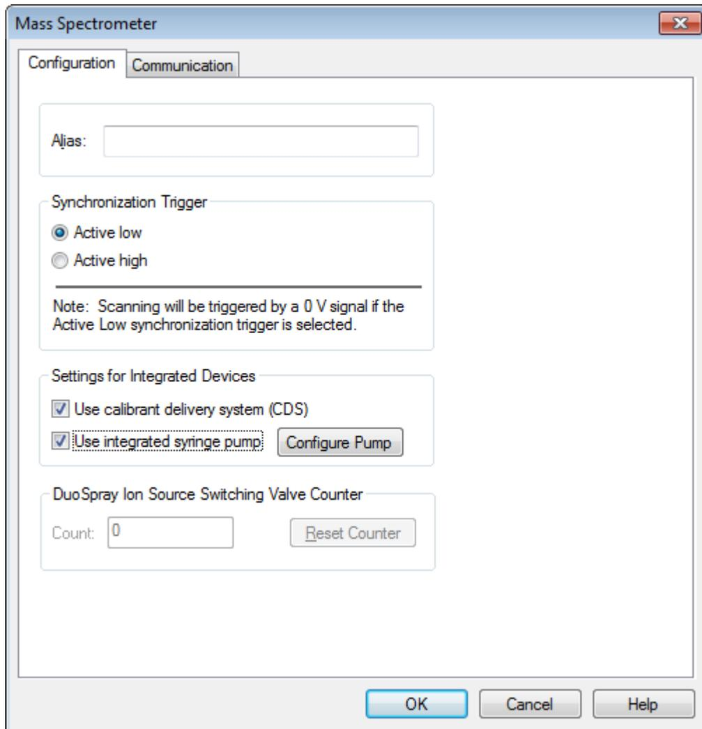
10. (Opzionale) Per configurare lo spettrometro di massa per il CDS, nella scheda **Configuration** (Configurazione), selezionare **Use calibrant delivery system (CDS)** (Usa sistema di erogazione calibrante).
