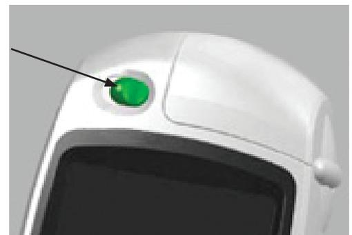
Inserire il dispositivo di test 3M nella camera. Sollevare il cappuccio in cima al dispositivo e premerlo verso il basso finché non si aggancia.
