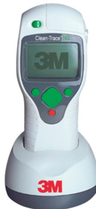
Per utilizzarla, è sufficiente posizionare il bioluminometro 3M™ Clean-Trace™ NGi nell'apertura e applicare una leggera pressione verso il basso. Se necessario, i connettori per la stampante, il PC e il caricatore possono essere lasciati sempre in posizione permanente.
