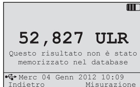
Per misurare un altro campione, rimuovere il test precedente, inserire il test successivo e premere il tasto **MISURA**.
