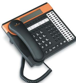
Nel predisporre il collegamento di telefoni di sistema ST 600 Personal Phone si devono prevedere, nei vari ambienti, prese RJ11 e il cablaggio va effettuato con un cavo a due coppie.
