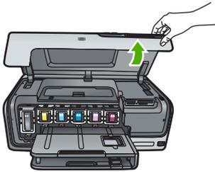
2. Schiacciare la linguetta grigia sotto un alloggiamento della cartuccia di inchiostro per rilasciare il dispositivo di blocco grigio all'interno della stampante, quindi sollevare il dispositivo di blocco.
