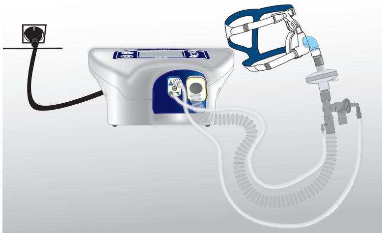
Figura 11: Esempio di sistema completamente assemblato (circuito singolo con valvola e linea di pressione)
