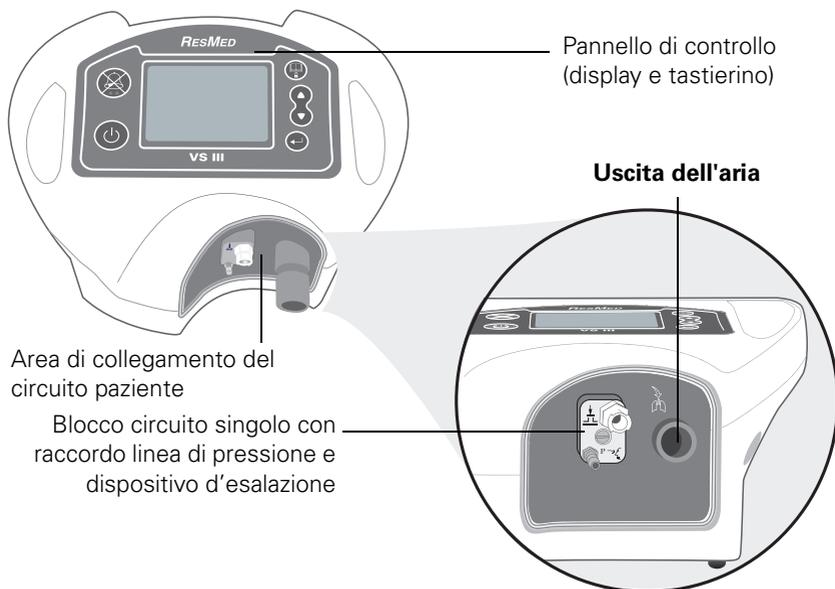
Figura 2: Vista anteriore dell'apparecchio (circuito singolo)
