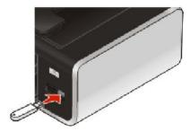
**Nota:** se non è possibile collegare l'unità flash direttamente alla porta, potrebbe essere necessario utilizzare un adattatore.
