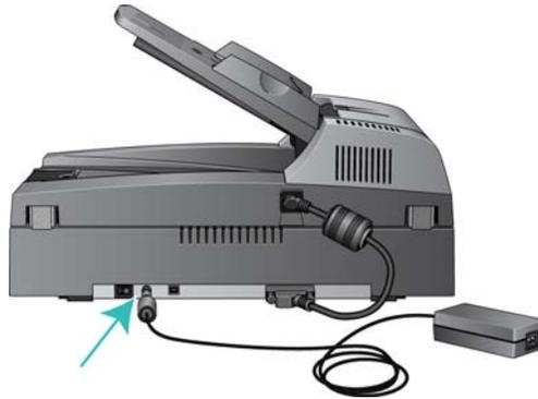
**Nota:** utilizzare solo l'alimentatore accluso allo scanner (HiTron HEG42-240200-7L o APD DA-48M24). L'uso di un altro tipo di alimentatore può danneggiare lo scanner e invalidarne la garanzia.
