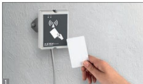
**Identificazione tramite RFID:** identificazione rapida e sicura di utenti, articoli, veicoli, ecc. tramite lettore di schede transponder RFID opzionale. I dati possono essere letti e modificati (adatto per ILT-BM, -GM, KET-TM)
