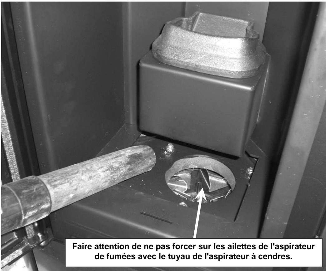
Aspirer le dépôt à l'intérieur en utilisant un aspirateur à cendres adéquat puis repositionner le fond et le tiroir à cendres.
