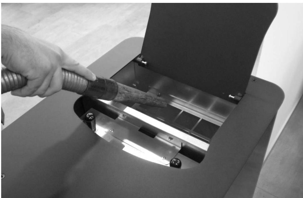
Pour un fonctionnement correct, il est nécessaire d'aspirer le dépôt de sciure sur le fond du réservoir au moins tous les 15 jours.
