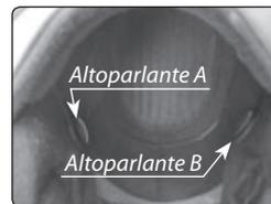
L'uso di due altoparlanti nel casco può essere proibito in alcune giurisdizioni. Se questo è il caso, mettere al sicuro l'altoparlante con il filo lungo sotto il rivestimento del casco come segue: far passare l'altoparlante [B] lungo il bordo del rivestimento sul lato destro e poi riportarlo sul lato sinistro, vicino all'altoparlante [A]. Poi mettere l'altoparlante [B] sotto il rivestimento.
