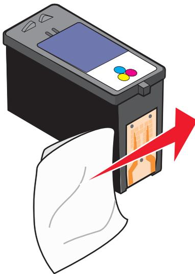
**5** Utilizzando un'altra sezione pulita del panno, ripetere passo 3 e passo 4.
