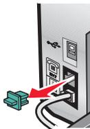
**Nota:** una volta che la spina è stata rimossa, qualsiasi apparecchiatura specifica per il paese collegata alla stampante tramite l'adattatore, come illustrato, non funzionerà correttamente.
