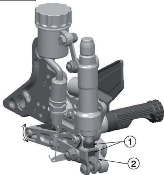
**ITA** ⚠ – Per trovare la posizione desiderata del pedale del freno avvitare o svitare la forchetta filettata OEM (2) e infine stringere i dadi OEM di sicurezza (1).
