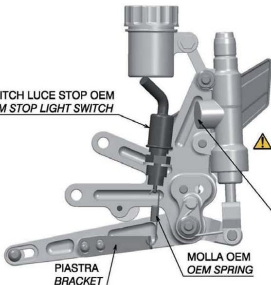
**ATTENZIONE:** RUOTARE IL TUBO OLIO PER MONTARE LO SWITCH
