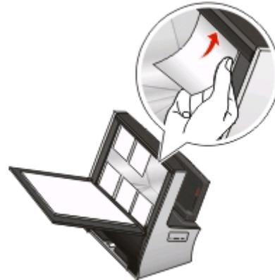
Usare i fermi dello scanner quando si caricano i supporti di piccole dimensioni sul vetro dello scanner.
