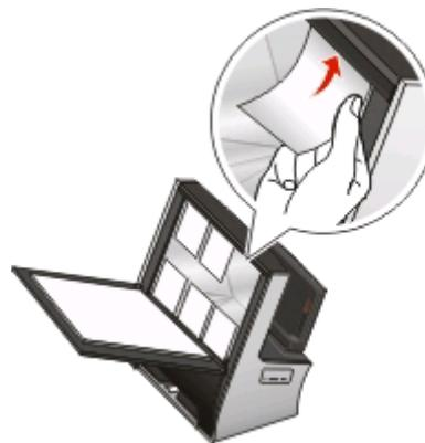
Usare i fermi dello scanner quando si caricano i supporti di piccole dimensioni sul vetro dello scanner.
