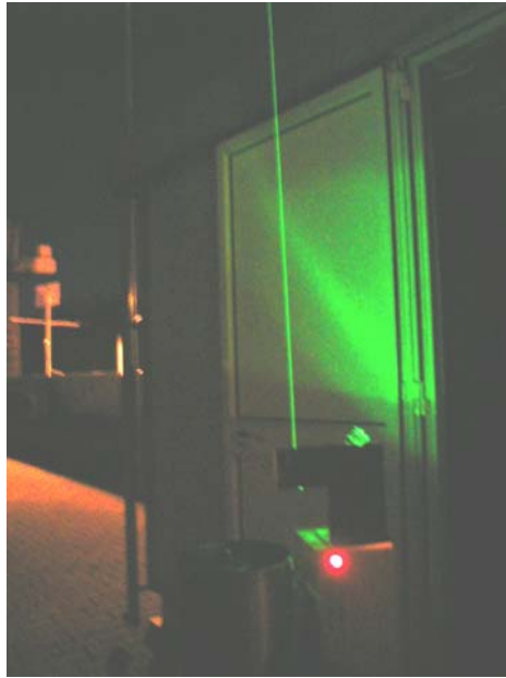
Figura 3-2 : Prototipo in funzione con emissione nel verde \lambda=532 nm
