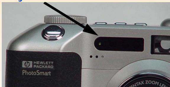
**Figura 26:** Finestra a infrarossi della fotocamera
