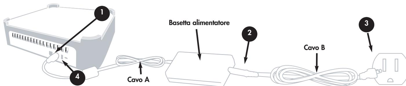
Con l'alimentatore vengono forniti due cavi: il primo cavo (A) deve essere collegato a una presa elettrica, ad esempio una presa a muro o a un dispositivo di protezione da sovraccarichi di corrente, mentre il secondo (B) deve essere collegato all'unità LaCie.
