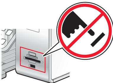
**Nota:** la stampante riconosce solo una periferica attiva alla volta. Se si inseriscono più dispositivi di memorizzazione, viene visualizzato un messaggio sul display che richiede di indicare il dispositivo che si desidera far riconoscere alla stampante.
