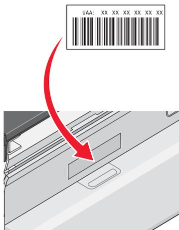
**Nota:** Un elenco di indirizzi MAC può essere impostato in un router in modo che solo le periferiche con indirizzi MAC possono operare nella rete. Viene definito *filtraggio MAC*. Se nel router è attivato il filtraggio MAC e si desidera aggiungere una stampante alla rete, l'indirizzo MAC della stampante deve essere incluso nell'elenco del filtro MAC.
