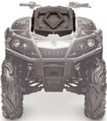
RADIATORE E PRESA D'ARIA RIPOSIZIONATI
