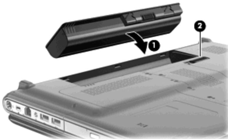
Per rimuovere la batteria, seguire le istruzioni riportate di seguito:
