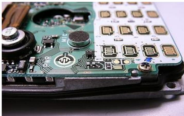
9. Rimuovere **solo il diodo superiore.** Ci dovrebbe essere un diodo in posizione centrale e la posizione inferiore deve essere lasciata vuota come nel originale.
