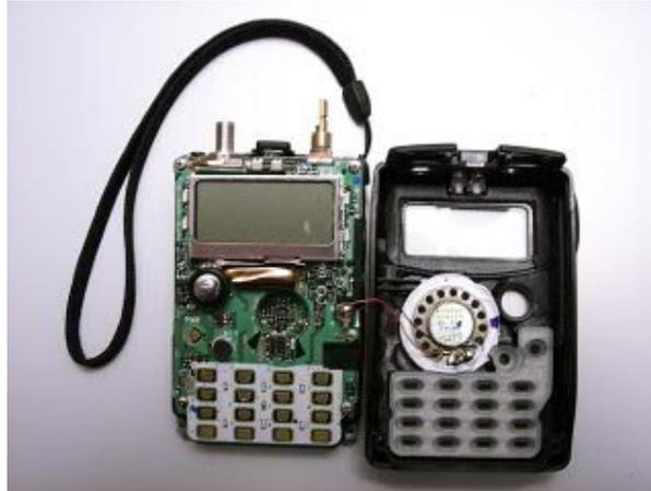
8. Con la radio **aperta come un libro**, guardare il lato sinistro del PCB appena a sinistra del PCB dove e' montato microfono.
