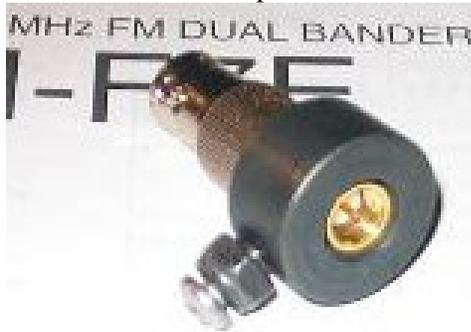
Si tratta di un **solido pezzo** di canna (io ho usato un tondino in acciaio, ma sarebbe meglio in **ottone**) con un buco da 0.350 e attraverso di esso una filettatura da 6 x 32 con una vite sul fianco.
