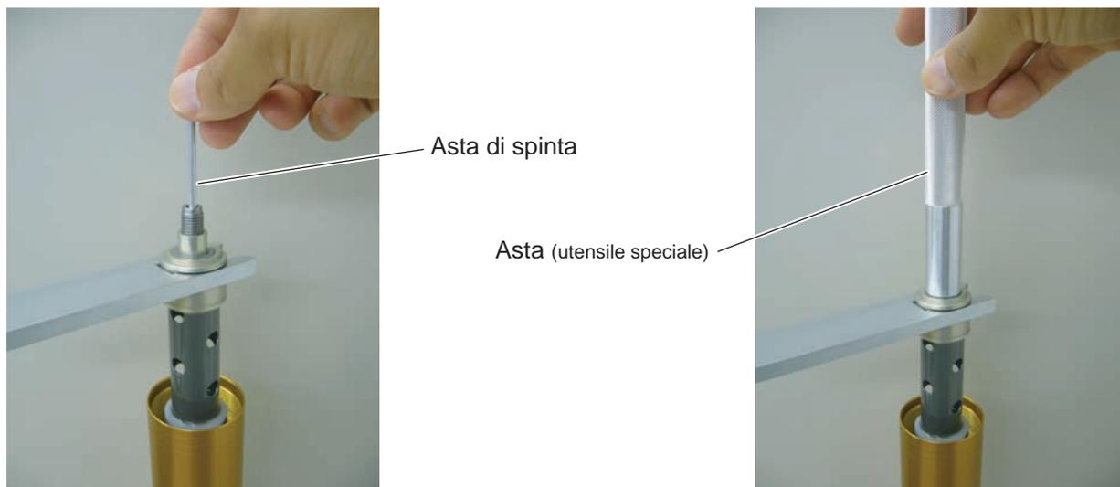
6. Afferrare saldamente l'asta (utensile speciale) e rimuovere la chiave (utensile speciale).
