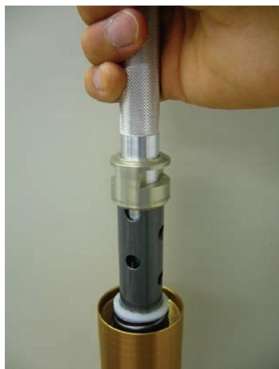
7. Prima di rimuovere l'asta (utensile speciale), rimuovere la parte superiore della sede della molla e il tubo di precarico.
