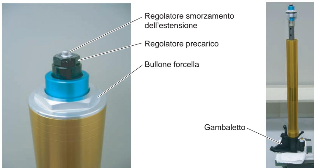
3. Inserire la chiave (utensile speciale) nell'incavo della sede superiore della molla e bloccare il dado speciale da 14 mm.
