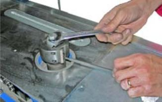
–Montare il coperchio di protezione fissandolo con i volantini dedicati (vedi fig.1 punti 22-30 e fig,9D).
