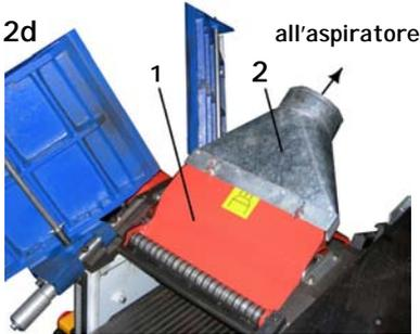
L'aspira trucioli è necessario per evitare intasamenti dovuti ai trucioli che non riescono ad essere espulsi.
