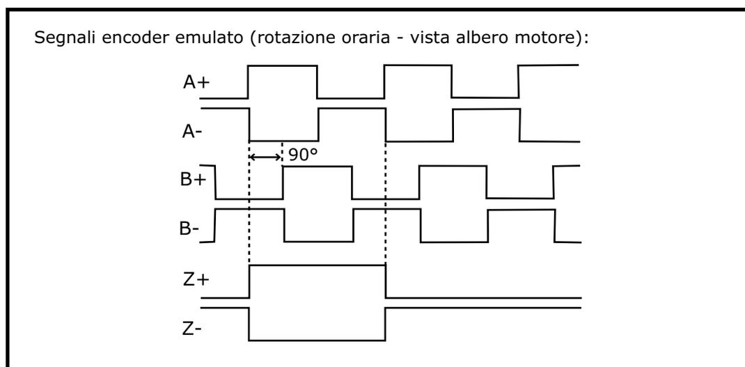
**Nota:** Se si utilizza un motore con retroazione da **resolver a 2 poli**, la *risoluzione massima* per l'encoder emulato sarà di **1024 impulsi/giro**, quindi i valori impostabili saranno 1024, 512, 256, 128, 64, 32, 16, 8.
