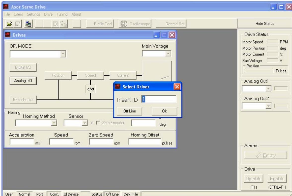
Se il PC non è collegato al convertitore o il convertitore non è alimentato, cliccando il tasto "**OFF line**" e successivamente l'icona "Open", si aprirà una finestra contenente un elenco di file di configurazione pre-impostati, i quali permetteranno di visualizzare una serie di parametri standard (Attenzione: il file di configurazione caricato potrebbe non corrispondere all'accoppiamento motore-drive a disposizione):
