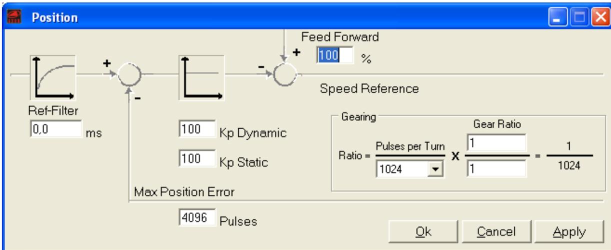
I parametri **FeedForward**, **Kp Dynamic**, **Kp Static**, **Max. Position Error** e **Ref-Filter** hanno le stesse funzioni precedentemente illustrate, ma possono essere tarati in modo diverso, mentre per quanto riguarda gli altri parametri:
