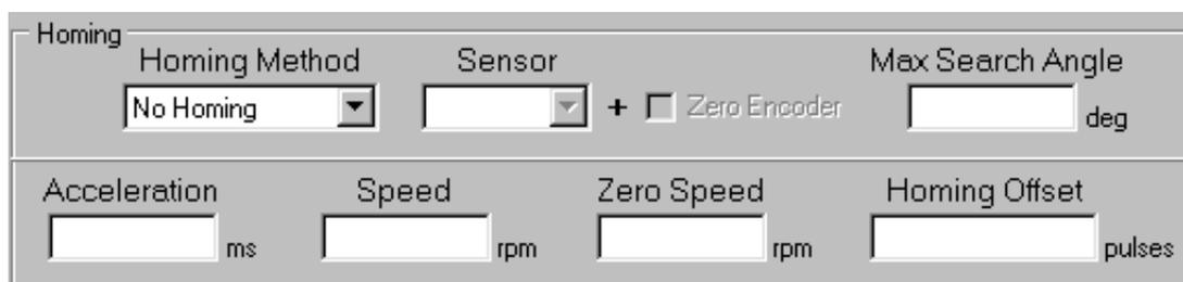
La procedura di homing viene eseguita utilizzando il segnale di un apposito  **sensore di homing** ed eventualmente il **segnale Z** dell'encoder.
