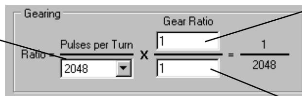
2) inserire al numeratore di Gear Ratio il valore impostato in "Pulse per Turn";
