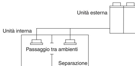
(Se c'è un'apertura senza porta o aperture sopra e sotto la porta, ognuna di dimensioni corrispondenti ad almeno 0,15% dell'area del pavimento.)
