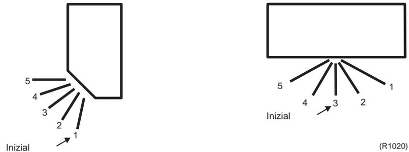
Anche se sul display LCD l'indicazione della direzione del flusso d'aria è la stessa nelle modalità raffreddamento, deumidificazione, riscaldamento (vedi figura), l'ampiezza degli angoli di oscillazione è leggermente diversa in ciascuna modalità operativa.
