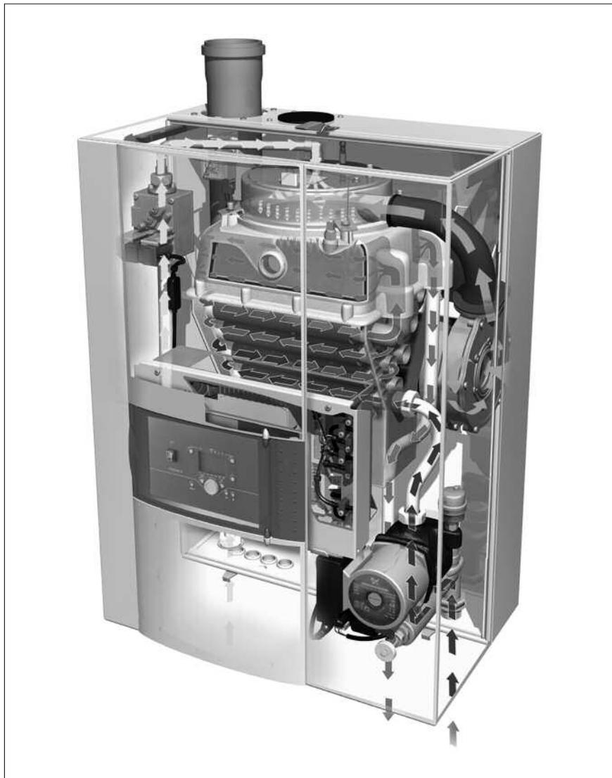
tura di mandata della caldaia. In caso di differenza tra temperatura effettiva e temperatura nominale, il regolatore reagisce immediatamente adattando il regime del ventilatore e dunque - tramite la valvola del gas - la potenza della caldaia. Una differenza si presenta nei seguenti casi:
