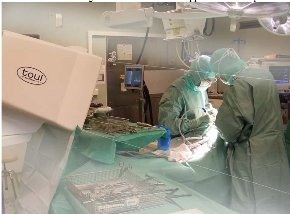
Figura 1: L'unità del TOUL 200 con il flusso d'aria ultrapulita diretto verso il sito chirurgico. La colonna d'aria pulita è illustrata in trasparenza nella foto.
