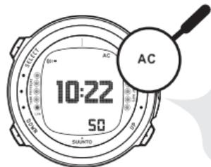
QUANDO IL COMPUTER DA IMMERSIONE È A CONTATTO CON L'ACQUA, COMPARE IL SIMBOLO AC NELL'ANGOLO SUPERIORE DESTRO DEL DISPLAY, CHE INOLTRE INDICA CHE È ATTIVA LA MODALITÀ DIVE.
