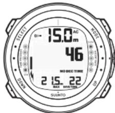
DISPLAY IN IMMERSIONE – LA PROFONDITÀ ATTUALE È DI 15 M, IL LIMITE DEL TEMPO DI STOP DI NON DECOMPRESSIONE È 46 MINUTI. LA MASSIMA PROFONDITÀ RAGGIUNTA È STATA DI 21,5 M, IL TEMPO TRASCORSO IN IMMERSIONE È 22 MINUTI.
