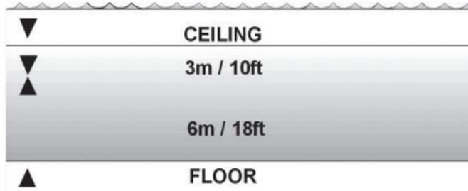
La profondità del Ceiling e del floor dipende dal proprio profilo di immersione. La profondità di massima sarà abbastanza bassa quando si entra in modalità di decompressione, ma se si rimane in profondità, scenderà e il tempo di risalita aumenterà. In modo analogo, durante la decompressione le profondità del floor e del ceiling possono aumentare.
