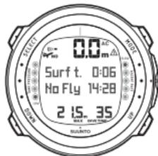
SONO TRASCORSI 6 MINUTI DALL'EMERSIONE DA UN'IMMERSIONE DI 35 MINUTI. LA PROFONDITÀ MASSIMA RAGGIUNTA ERA DI 21.5 M. LA PROFONDITÀ ATTUALE È DI 0.0 M. IL SIMBOLO DELL'AEREO E IL VALORE DI NON VOLO INDICANO CHE È SCONSIGLIATO VOLARE PER LE PROSSIME 14 ORE E 28 MINUTI. IL SIMBOLO DI ATTENZIONE PER IL SUB INDICA CHE È NECESSARIO PROLUNGARE LA DURATA DELL'INTERVALLO DI SUPERFICIE.
