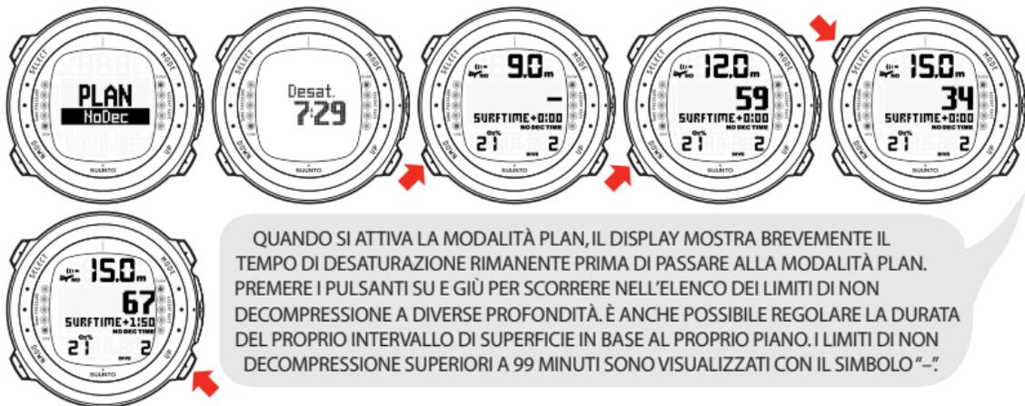
QUANDO SI ATTIVA LA MODALITÀ PLAN, IL DISPLAY MOSTRA BREVEMENTE IL TEMPO DI DESATURAZIONE RIMANENTE PRIMA DI PASSARE ALLA MODALITÀ PLAN. PREMERE I PULSANTI SU E GIÙ PER SCORRERE NELL'ELENCO DEI LIMITI DI NON DECOMPRESSIONE A DIVERSE PROFONDITÀ. È ANCHE POSSIBILE REGOLARE LA DURATA DEL PROPRIO INTERVALLO DI SUPERFICIE IN BASE AL PROPRIO PIANO. I LIMITI DI NON DECOMPRESSIONE SUPERIORI A 99 MINUTI SONO VISUALIZZATI CON IL SIMBOLO "—".
