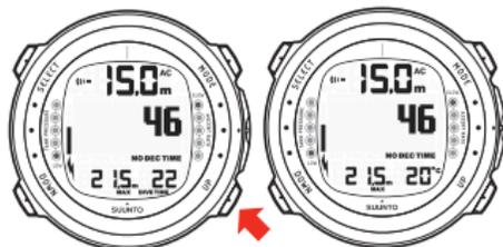
PREMENDO IL PULSANTE UP SI PASSA DAL TEMPO DI IMMERSIONE ALLA TEMPERATURA DELL'ACQUA.
