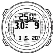
LA FRECCIA VERSO L'ALTO, IL TEMPO DI RISALITA CHE LAMPEGGIA E UN ALLARME INDICANO CHE È NECESSARIO RISALIRE. IL TEMPO DI RISALITA TOTALE MINIMO, CON SOSTA DI SICUREZZA, È DI 9 MINUTI. IL LIVELLO DEL MASSIMALE È 3 METRI.
