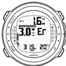
IMMERSIONE CON DECOMPRESSIONE, SOPRA IL TETTO. NOTARE LA FRECCIA VERSO IL BASSO, L'AVVISO ER E L'ALLARME. È NECESSARIO SCENDERE IMMEDIATAMENTE (ENTRO 3 MINUTI) AL TETTO O AD UNA PROFONDITÀ MAGGIORE.
