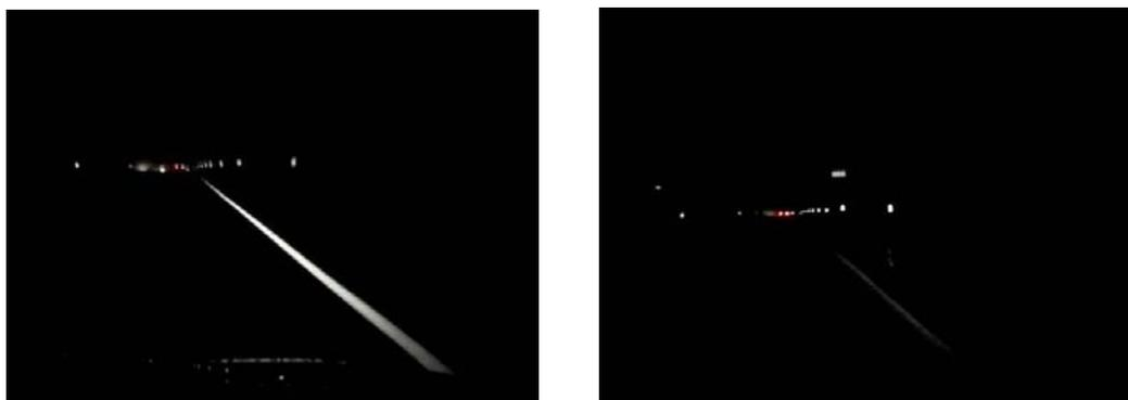
Fig. IV.4 - Esempio di segnaletica stradale retroriflettente in condizioni di strada asciutta e bagnata.
