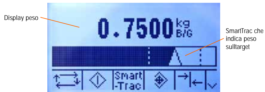
Figura 2-13: SmartTrac Trasferimento materiali di piccola dimensione
