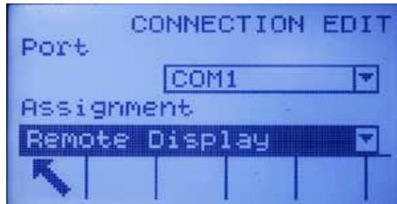
Figura 3-8: Connessione COM1 configurata per display remoto
