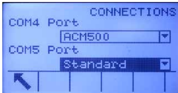
Figura 3-9: Connessione COM4 configurata per l'ACM500
