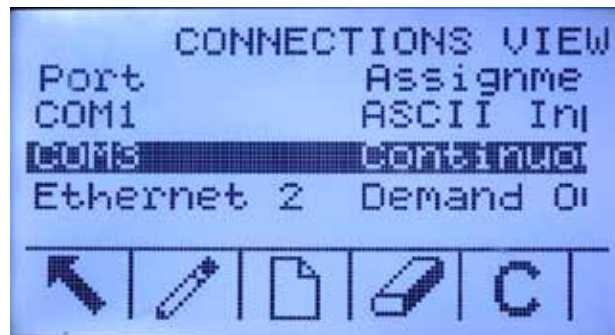
Figura 3-21: Schermata di configurazione della visualizzazione delle connessioni
