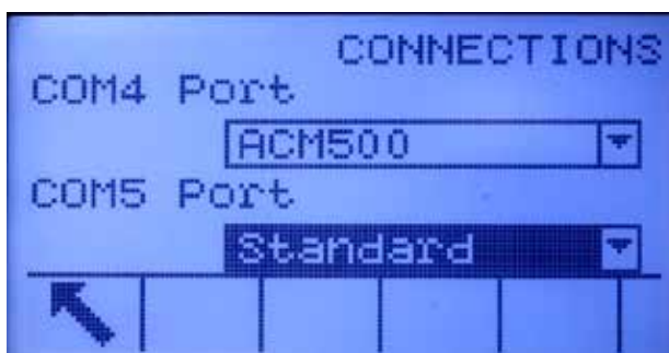
Figura 3-18: Configurazione di COM4 e COM5
