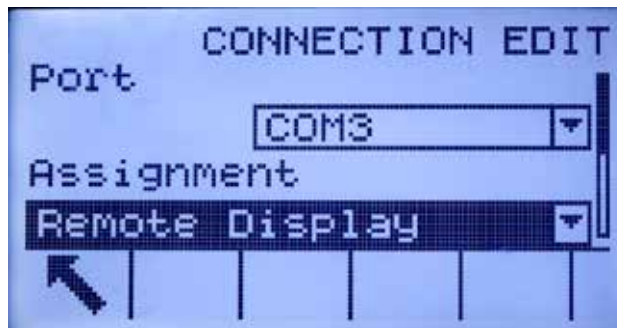
Figura 3-10: Connessione COM2/COM3 configurata per il funzionamento remoto
