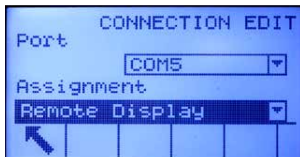
Figura 3-12: Connessione COM4 o COM5 configurata per il funzionamento remoto
