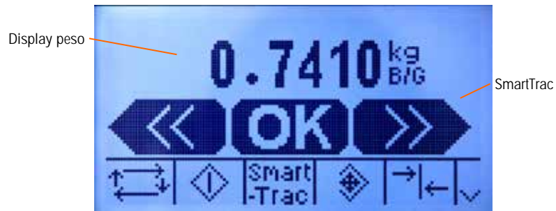
Figura 2-18: Visualizzazione Sopra/Sotto di piccola dimensione
