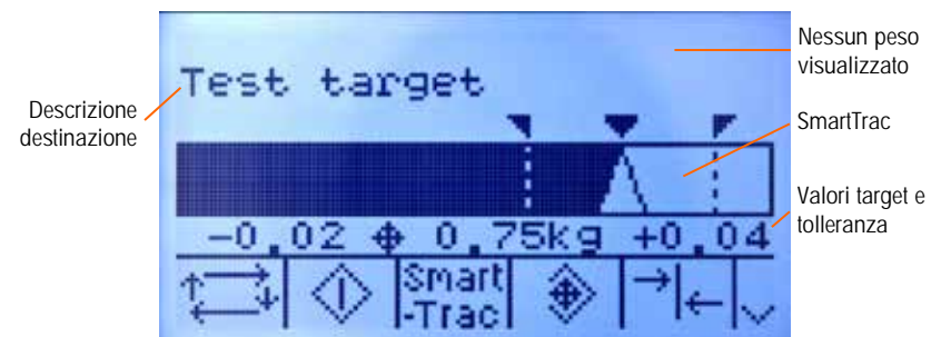
Figura 2-15: SmartTrac Trasferimento materiali di grande dimensione
