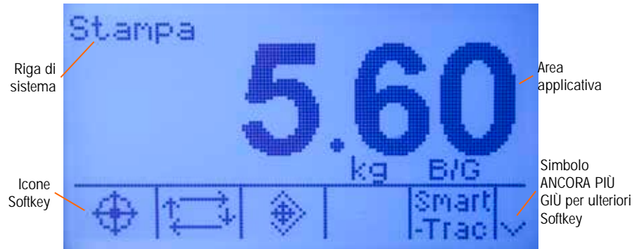
Figura 2-9: Schermata dell'operazione di pesa predefinita, visualizzazione del messaggio di sistema
