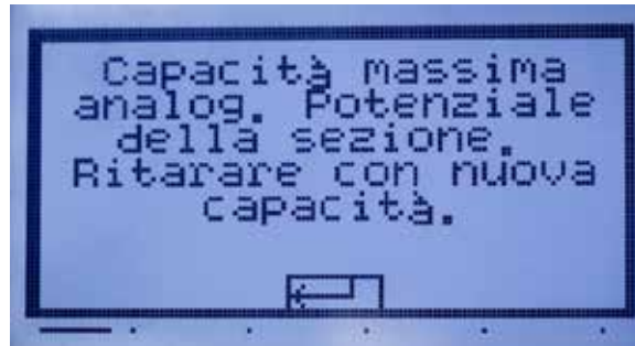
Figura 3-14: Avviso di saturazione analogica
