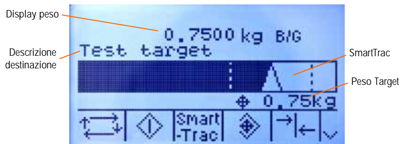
Figura 2-14: SmartTrac Trasferimento materiali di media dimensione
