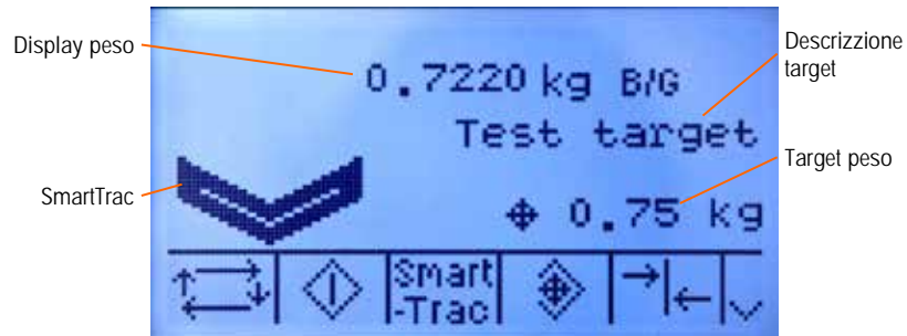
Figura 2-19: Visualizzazione Sopra/Sotto di media dimensione
