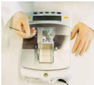
La protezione anticorrente del modello da 0,001 mg è stata ideata specificamente per consentire operazioni di pesata estremamente agevoli anche in caso di minime quantità da campionare. Nella serie Competence vi sono inoltre microbilance complete di protezione anticorrente progettata appositamente per la pesatura di filtri.
