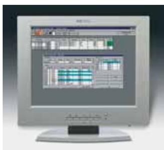
Grazie al concetto di programmazione indipendente del costruttore è possibile configurare facilmente i controllori Sartorius per soddisfare le richieste più diverse. I controllori di processo utilizzano degli standard di programmazione internazionale secondo la normativa IEC 61131.
