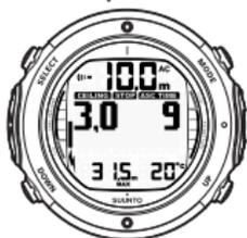
LA SCOMPARSA DELLA FRECCIA VERSO L'ALTO E L'ARRESTO DEL LAMPEGGIO DEL TEMPO DI RISALITA INDICANO CHE SI È NEL CAMPO DI DECOMPRESSIONE.
