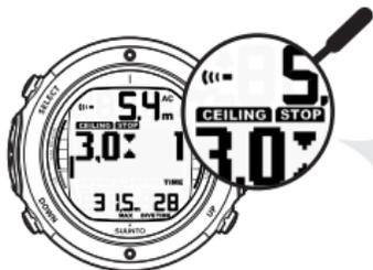
QUANDO COMPAIONO LE SCRITTE STOP E CEILING, EFFETTUARE UNA SOSTA DI SICUREZZA OBBLIGATORIA DI UN MINUTO NEL CAMPO DI PROFONDITÀ COMPRESO TRA 6 METRI E 3 METRI.
