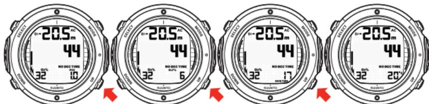
PREMENDO IL PULSANTE UP SI PASSA DA UNA ALL'ALTRA DELLE SEGUENTI FUNZIONI: PO<sub>2</sub>, OLF%, TEMPO DI IMMERSIONE E TEMPERATURA DELL'ACQUA.
