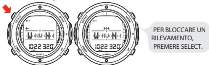
Suunto D6i permette inoltre di seguire rotte a triangolo o a quadrato e facilita la localizzazione della rotta del ritorno. Per far ciò, basta seguire i simboli grafici visualizzati al centro del display della bussola:
