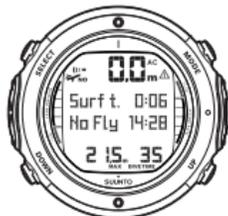
SONO TRASCORSI 6 MINUTI DALL'EMERSIONE DA UN'IMMERSIONE DI 35 MINUTI. LA PROFONDITÀ MASSIMA RAGGIUNTA ERA DI 21.5 M. LA PROFONDITÀ ATTUALE È DI 0.0 M. IL SIMBOLO DELL'AEREO E IL VALORE DI NON VOLO INDICANO CHE È SCONSIGLIATO VOLARE PER LE PROSSIME 14 ORE E 28 MINUTI. IL SIMBOLO DI ATTENZIONE PER IL SUB INDICA CHE È NECESSARIO PROLUNGARE LA DURATA DELL'INTERVALLO DI SUPERFICIE.
