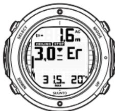
IMMERSIONE CON DECOMPRESSIONE, SOPRA IL TETTO. NOTARE LA FRECCIA VERSO IL BASSO, L'AVVISO ER E L'ALLARME. È NECESSARIO SCENDERE IMMEDIATAMENTE (ENTRO 3 MINUTI) AL TETTO O AD UNA PROFONDITÀ MAGGIORE.
