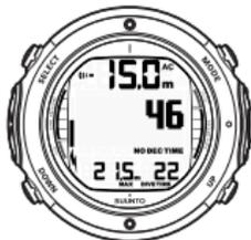
DISPLAY IN IMMERSIONE – LA PROFONDITÀ ATTUALE È DI 15 M, IL LIMITE DEL TEMPO DI STOP DI NON DECOMPRESSIONE È 46 MINUTI. LA MASSIMA PROFONDITÀ RAGGIUNTA È STATA DI 21,5 M, IL TEMPO TRASCORSO IN IMMERSIONE È 22 MINUTI.
