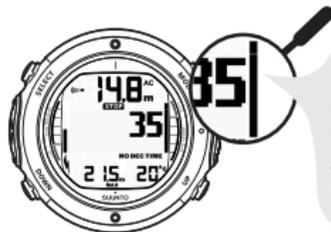
L'ATTIVAZIONE DELLA RETROILLUMINAZIONE E DELL'ALLARME E IL LAMPEGGIO DELLA BARRA DELLA VELOCITÀ DI RISALITA INDICANO CHE LA RISALITA AVVIENE AD UNA VELOCITÀ SUPERIORE A 10 M/MIN E CHE È NECESSARIO EFFETTUARE UNA SOSTA DI SICUREZZA OBBLIGATORIA QUANDO SI ARRIVA ALLA PROFONDITÀ DI 6 M.
