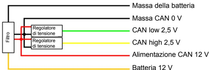
CANBUS è un sistema a quattro fili che comprende CAN high (giallo), CAN low (verde), alimentazione CAN (rosso) e massa CAN (nero). Inoltre, CANBUS comprende un alimentatore elettrico, anche denominato "terminatore attivo", con alimentazione batteria e massa della batteria per mantenere il livello del CANBUS alla tensione desiderata. L'illustrazione riportata sopra mostra il terminatore attivo come filtro e regolatore di tensione.
