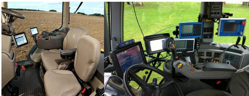
Trattore John Deere con display GreenStar 2630 (compatibile ISOBUS)
