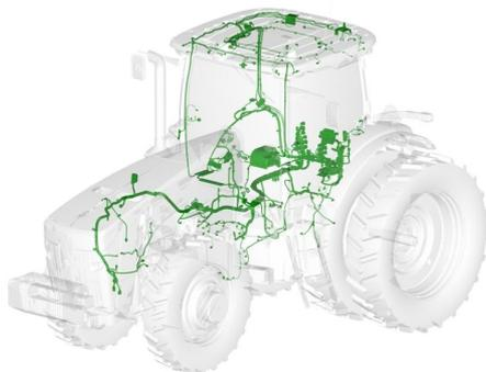
CANBUS è un cavo che si estende dalla parte anteriore a quella posteriore della macchina. Tutte le unità di comando sulla macchina possono comunicare tra di esse grazie a questo sistema CANBUS. Tali unità possono comprendere l'unità di comando motore, l'unità di comando idraulica e l'unità di comando della trasmissione.
