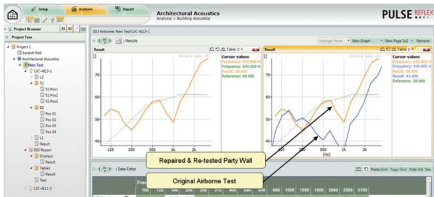
Fig. 11 Progetto tipico di acustica architettonica utilizzando il tipo 8780. I dati sono presentati in forma numerica e grafica con le indicazioni dettagliate sulla qualità dei dati, utilizzando il sistemadi smiley del Tipo 2250/2270
