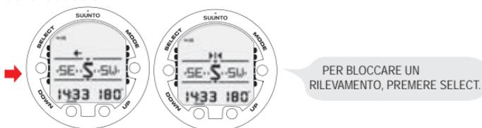
Suunto Vyper2 inoltre aiuta nei profili di navigazione quadrati e triangolari e facilita la localizzazione della rotta di ritorno. Per far ciò, basta seguire i simboli grafici visualizzati al centro del display della bussola:
