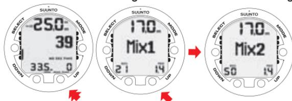
CAMBIO DELLA MISCELA DI GAS. SCORRERE NELL'ELENCO DELLE MISCELE ATTIVE PREMENDO I PULSANTI UP E DOWN. SELEZIONARE LA NUOVA MISCELA PREMENDO IL PULSANTE SELECT.
