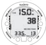
DISPLAY IMMERSIONE - PROFONDITÀ ATTUALE: 15 METRI, LIMITE DEL TEMPO DI STOP DI NON DECOMPRESSIONE: 38 MINUTI, TEMPO DI IMMERSIONE TRASCORSO: 13 MINUTI.
