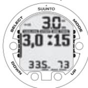
DUE FRECCHE RIVOLTE UNA VERSO L'ALTRA: "CLESSIDRA". SI RAGGIUNGE LA ZONA DEL MASSIMALE OTTIMALE A 3 METRI. IL TEMPO DI RISALITA MINIMO È DI 15 MINUTI.
