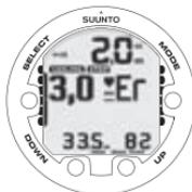
IMMERSIONE CON DECOMPRESSIONE, AL DI SOPRA DEL MASSIMALE. PRESTARE ATTENZIONE ALLA FRECCIA VERSO IL BASSO, ALL'AVVISO E ALL'ALLARME. È NECESSARIO SCENDERE IMMEDIATAMENTE (ENTRO 3 MINUTI) AL LIVELLO DEL MASSIMALE O A UNA PROFONDITÀ MAGGIORE.
