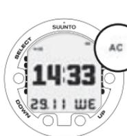
QUANDO IL COMPUTER DA IMMERSIONE È A CONTATTO CON L'ACQUA, COMPARE IL SIMBOLO AC NELL'ANGOLO SUPERIORE DESTRO DEL DISPLAY, CHE INOLTRE INDICA CHE È ATTIVA LA MODALITÀ DIVE.
