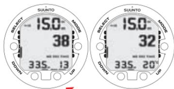
PREMENDO IL PULSANTE UP SI PASSA DAL TEMPO DI IMMERSIONE ALLA TEMPERATURA DELL'ACQUA.
