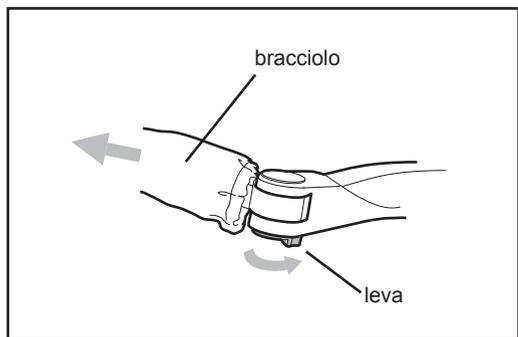
Per sganciare il bracciolo di protezione, apertura solo sul lato destro, girare nel senso antiorario la levetta destra, posta sul lato inferiore del bracciolo, come indicato in figura e mantenendola ruotata, tirare il bracciolo aprendolo a cancelletto.
