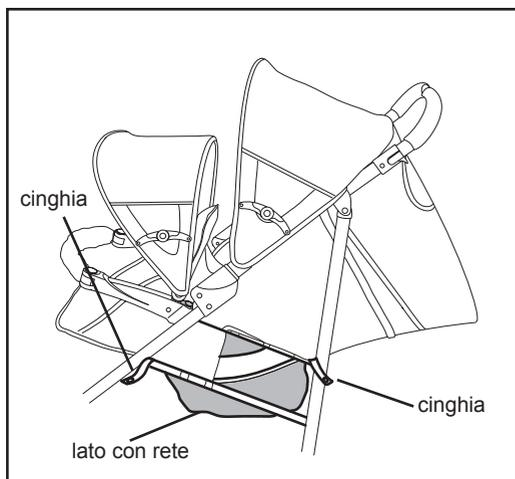
Si fissa e si toglie il cesto inferiore, sotto il passeggino, tramite i bottoni automatici posti sulle 4 cinghie del cesto.
