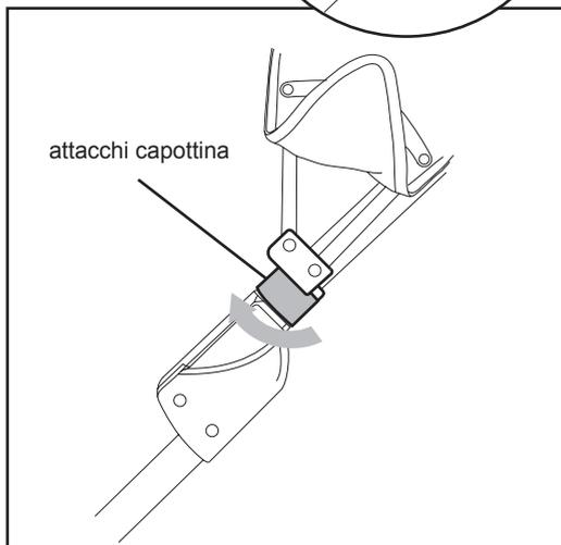
Tenendo gli agganci della capottina, ruotateli leggermente di circa  $90^\circ$  per facilitare l'aggancio al telaio del passeggino. Dopo aver calzato sul telaio gli agganci, premere e ruotarli verso l'esterno per completare il fissaggio. Assicuratevi che entrambi gli agganci, siano fissati al telaio correttamente.
