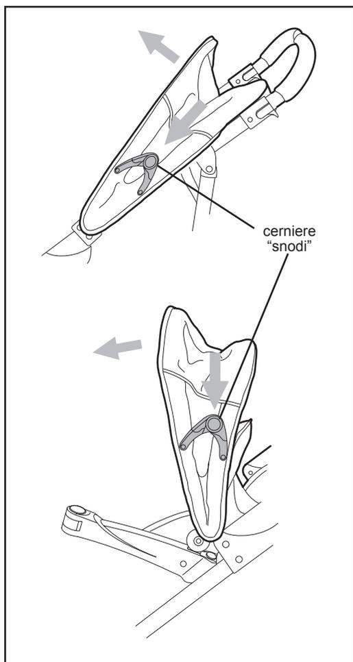
La capottina ed il tettuccio parasole sono fornite di cerniere "snodi" da ambo i lati per consentirne l'apertura.
