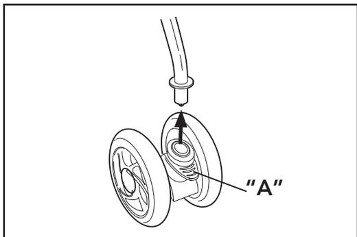
Per fissare le ruote anteriori, spingete il gruppo ruota sulle gambe anteriori del telaio. Assicuratevi che il gruppo ruote sia fissato correttamente.
