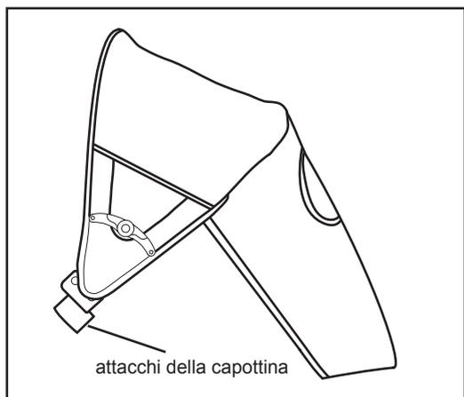
Per agganciare la capottina: Fissare gli agganci della capottina sul telaio del passeggino al punto di fissaggio come mostrato in figura.
