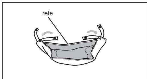
Il cesto inferiore può essere fissato in un senso o nell'altro a condizione che la parte con la rete sia sempre a lato del passeggino. Infilate le cinghie intorno al telaio del passeggino e agganciate i bottoni automatici.
