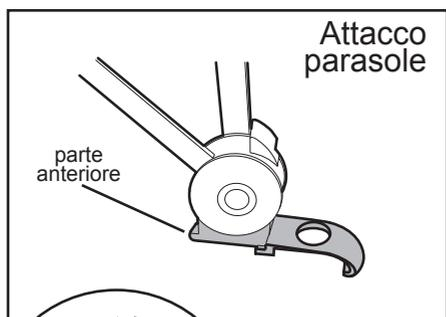
Tenendo gli attacchi del parasole leggermente inclinati, inserite la parte anteriore di ogni attacco nella fessura sul bracciolo del passeggino. Premere verso basso e fate scorrere in avanti il dispositivo d'aggancio. Assicuratevi del corretto inserimento.
