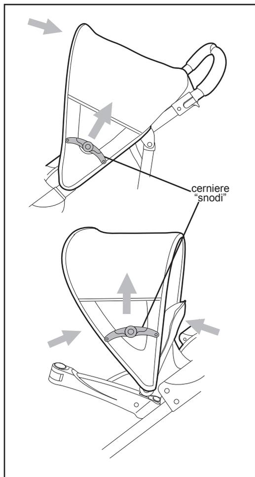
**Importante:** per chiudere la capottina o il tettuccio parasole, sollevare le cerniere, da ambo i lati, e ripiegare verso la parte posteriore del passeggino la capottina ed il parasole. Non richiudere la capottina o il tettuccio parasole senza prima aver sollevato le cerniere.
