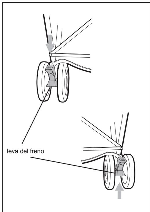
Per azionare i freni, premere con il piede sulla leva del freno destra o sinistra, finché il meccanismo non azioni il dispositivo frenante.
