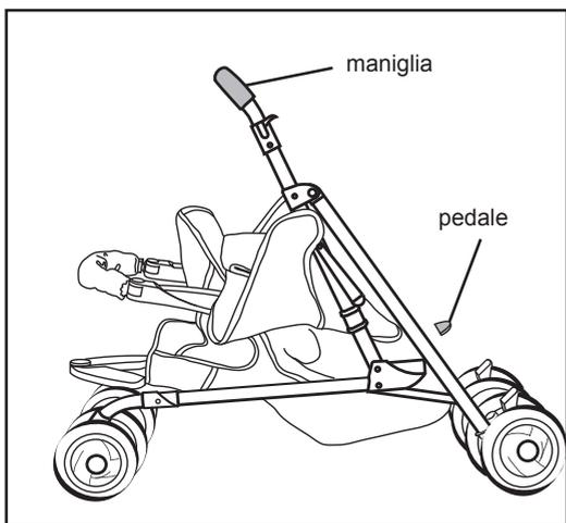
Quando il passeggino è quasi completamente sollevato, mettete il piede sul pedale e continuate a tirare le maniglie finché il passeggino non sia completamente aperto.
