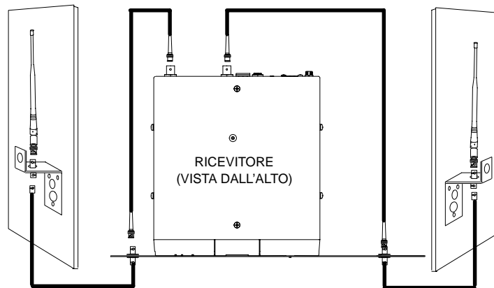
INSTALLAZIONE DELLE ANTENNE A DISTANZA
