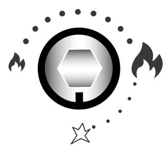
Questa posizione consente un'apertura completa della valvola con apporto massimo d'aria nella camera di combustione per facilitare l'accensione.
