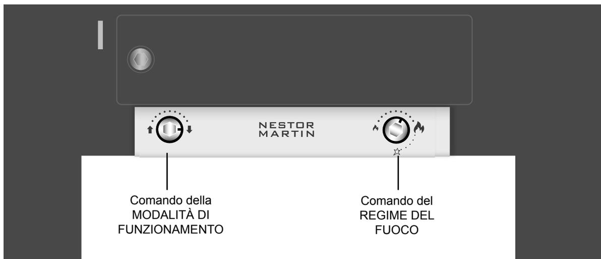
I comandi azionano delle valvole che possono aprirsi e chiudersi in diversi modi apportando aria sul fuoco in modo da ottimizzare la combustione in funzione del combustibile e dell'intensità desiderata.
