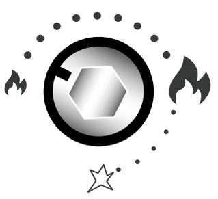
Quando la manopola viene ruotata in senso orario, la valvola si apre progressivamente per lasciar passare sempre più aria nella stufa.
