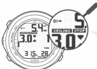
QUANDO COMPAIONO LE SCRITTE STOP E CEILING, EFFETTUARE UNA SOSTA DI SICUREZZA OBBLIGATORIA DI UN MINUTO NEL CAMPO DI PROFONDITÀ COMPRESO TRA 6 METRI E 3 METRI.
