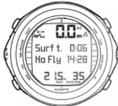
SONO TRASCORSI 6 MINUTI DALL'EMERSIONE DA UN'IMMERSIONE DI 35 MINUTI. LA PROFONDITÀ MASSIMA RAGGIUNTA ERA DI 21.5 M. LA PROFONDITÀ ATTUALE È DI 0.0 M. IL SIMBOLO DELL'AEREO E IL VALORE DI NON VOLO INDICANO CHE È SCONSIGLIATO VOLARE PER LE PROSSIME 14 ORE E 28 MINUTI. IL SIMBOLO DI ATTENZIONE PER IL SUB INDICA CHE È NECESSARIO PROLUNGARE LA DURATA DELL'INTERVALLO DI SUPERFICIE.
