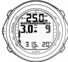
LA FRECCIA VERSO L'ALTO, IL TEMPO DI RISALITA CHE LAMPEGGIA E UN ALLARME INDICANO CHE È NECESSARIO RISALIRE. IL TEMPO DI RISALITA TOTALE MINIMO, CON SOSTA DI SICUREZZA, È DI 9 MINUTI. IL LIVELLO DEL MASSIMALE È 3 METRI.
