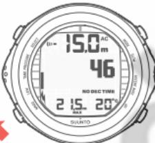
PREMENDO IL PULSANTE UP SI PASSA DAL TEMPO DI IMMERSIONE ALLA TEMPERATURA DELL'ACQUA.
