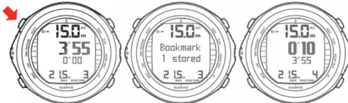
PREMENDO IL PULSANTE SELECT DURANTE UN'IMMERSIONE, SI FISSA UN SEGNALIBRO NELLA MEMORIA DI PROFILO, IL TIMER DI IMMERSIONE È AZZERATO E L'INTERVALLO DI TEMPO MISURATO PRECEDENTEMENTE È VISUALIZZATO IN BASSO.
