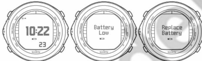
Se in modalità Surface appare il simbolo batteria o se il display è sbiadito o debole, la batteria potrebbe essere troppo scarica per alimentare correttamente il computer. Se ne raccomanda la sostituzione immediata.
