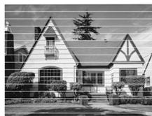
In caso di ostruzione di un ugello delle testine di stampa, la prova di stampa avrà l'aspetto seguente.
