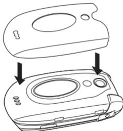
Installare la cover allineando i fori in modo da adattarli al display LCD esterno, al LED e alla camera.
