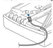
10 Inserire accuratamente il cavo di rete nella canalina come mostrato di seguito, disponendo il cavo intorno e verso il lato posteriore dell'apparecchio.
