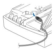
12 Inserire accuratamente il cavo USB nella canalina come mostrato di seguito, disponendo il cavo intorno e verso il lato posteriore dell'apparecchio.
