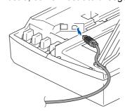
Inserire accuratamente il cavo USB nella canalina come mostrato di seguito, disponendo il cavo intorno e verso il lato posteriore dell'apparecchio. Quindi, collegarlo al Macintosh<sup>®</sup>.
