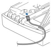
Inserire accuratamente il cavo di rete nella canalina come mostrato di seguito, disponendo il cavo intorno e verso il lato posteriore dell'apparecchio. Quindi, collegare il cavo alla rete.
