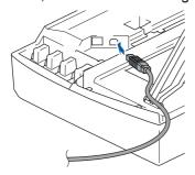
10 Inserire accuratamente il cavo USB nella canalina come mostrato di seguito, disponendo il cavo intorno e verso il lato posteriore dell'apparecchio.
