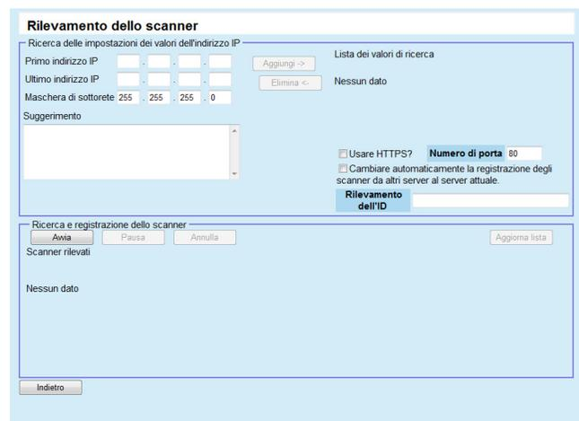
**3** Specificare il valore di ricerca della rete e la maschera di sottorete.
