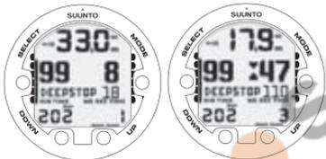
È NECESSARIO EFFETTUARE UNA SOSTA DI PROFONDITÀ A 18 M. L'INDICATORE DEI SECONDI MOSTRA CHE MANCANO 110 SECONDI AL COMPLETAMENTO DI TALE SOSTA.
