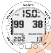
DISPLAY IMMERSIONE - LA PROFONDITÀ ATTUALE È DI 15 M, IL LIMITE DEL TEMPO DI STOP DI NON DECOMPRESSIONE È DI 38 MIN. IL TEMPO DI IMMERSIONE TRASCORSO È DI 13 MIN. IL TEMPO D'ARIA RIMANENTE È DI 99 MINUTI E LA PRESSIONE DELLA BOMBOLA È DI 202 BAR.
