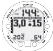
LA FRECCIA VERSO L'ALTO, IL TEMPO DI RISALITA CHE LAMPEGGIA E UN ALLARME INDICANO CHE È NECESSARIO RISALIRE. IL TEMPO DI RISALITA TOTALE MINIMO, CON SOSTA DI SICUREZZA OBBLIGATORIA, È DI 15 MINUTI. IL LIVELLO DEL MASSIMALE È 3 METRI.
