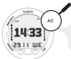
QUANDO IL COMPUTER DA IMMERSIONE È A CONTATTO CON L'ACQUA, COMPARE IL SIMBOLO AC NELL'ANGOLO SUPERIORE DESTRO DEL DISPLAY, CHE INOLTRE INDICA CHE È ATTIVA LA MODALITÀ DIVE.
