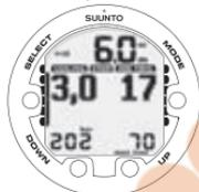
QUANDO LA FRECCIA VERSO L'ALTO SCOMPARE E L'INDICAZIONE DEL TEMPO DI RISALITA SMETTE DI LAMPEGGIARE SIGNIFICA CHE SI È NELL'INTERVALLO DI DECOMPRESSIONE.
