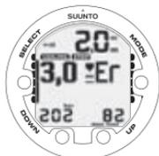
IMMERSIONE CON DECOMPRESSIONE, AL DI SOPRA DEL MASSIMALE. PRESTARE ATTENZIONE ALLA FRECCIA VERSO IL BASSO, ALL'AVVISO E ALL'ALLARME ER. È NECESSARIO SCENDERE IMMEDIATAMENTE (ENTRO 3 MINUTI) AL LIVELLO DEL MASSIMALE O A UNA PROFONDITÀ MAGGIORE.
