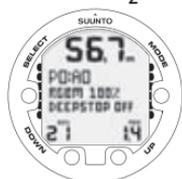
ATTIVAZIONE MODALITÀ NITROX DIVE (IMMERSIONE CON NITROX). MASSIMA PROFONDITÀ OPERATIVA IN BASE ALLA %O<sub>2</sub>, IMPOSTATA (21%) E AL VALORE DI PO<sub>2</sub> (1,4 BAR): 56,7 METRI.
