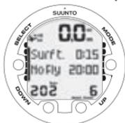
SONO TRASCORSI 15 MINUTI DALL'EMERSIONE DA UN'IMMERSIONE DI 6 MINUTI. LA PROFONDITÀ ATTUALE È DI 0,0 METRI. IL SIMBOLO DELL'AEREO E IL VALORE NO-FLY INDICANO CHE È SCONSIGLIATO VOLARE PER LE 20 ORE SUCCESSIVE.
