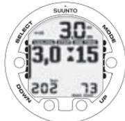
DUE FRECCIE RIVOLTE UNA VERSO L'ALTRA: "CLESSIDRA". SI RAGGIUNGE LA ZONA DEL MASSIMALE OTTIMALE A 3 METRI. IL TEMPO DI RISALITA MINIMO È DI 15 MINUTI.
