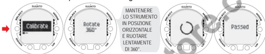
Se la taratura fallisce per cinque volte di seguito vuol dire che vi trovate in un'area ricca di fonti di magnetismo, come per esempio grandi oggetti metallici, linee elettriche o apparecchiature elettriche. Spostatevi dalla zona e riprovate a tarare la bussola. Se la taratura continua ad avere esito negativo, consigliamo di contattare un centro di assistenza Suunto autorizzato.
