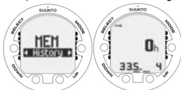
DISPLAY DELL'ARCHIVIO DI IMMERSIONE. NUMERO TOTALE DI IMMERSIONI, ORE DI IMMERSIONE E PROFONDITÀ MASSIMA.
