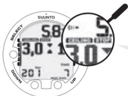
QUANDO IL DISPLAY INDICA STOP E CEILING, EFFETTUARE UNA SOSTA DI SICUREZZA OBBLIGATORIA DI UN MINUTO NEL CAMPO DI PROFONDITÀ COMPRESO TRA 6 E 3 METRI.
